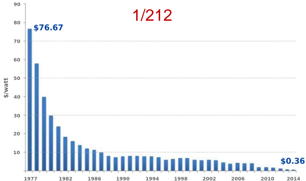
A szilikonos PV egységek árának teljesítményarányos változása 1977 és 2014 között. Forrás: Bloomberg New Energy Finance
